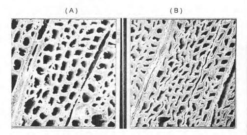
Figura 2. Deformación de la estructura anatómica en función de la intensidad de colapso. A. Madera con baja intensidad de colapso. B. Madera con alta intensidad de colapso. (Vista transversal a través del microscopio electrónico).
