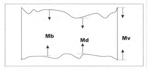
Figura. 1. Localización de las mediciones para índice del colapso.
